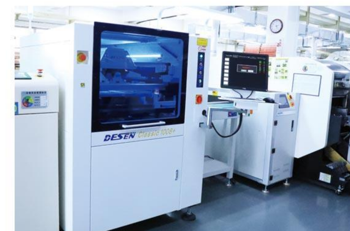
德森锡膏印刷机 Desen solder paste printing machine
