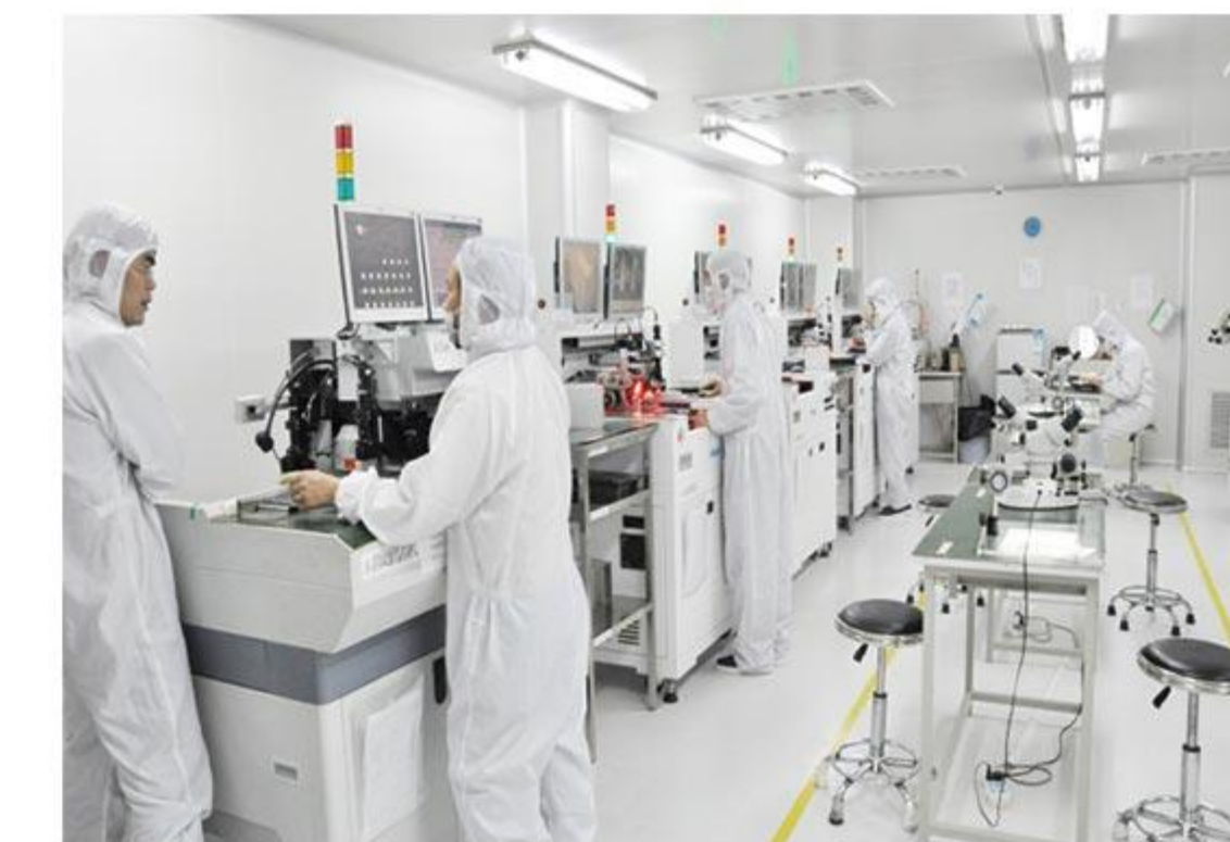
全自动固晶流水线 LED automatic die bonder assembly line
